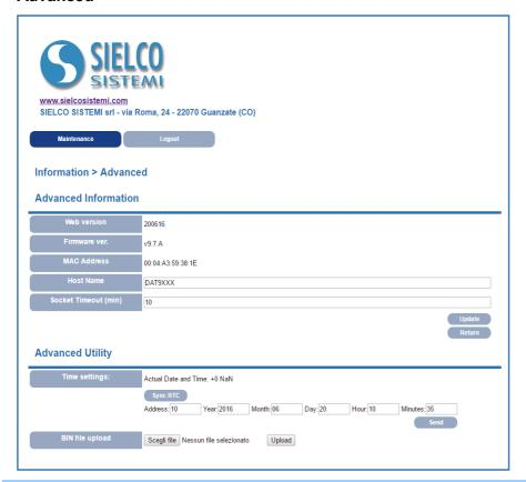
In questa selzione è possibile visualizzare i parametri di fabbrica del dispositivo come il nome, data e ora, MAC...
