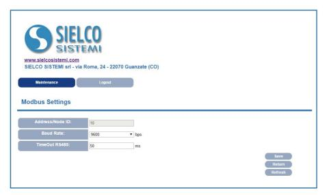
Address/Node ID: permette di visualizzare l'indirizzo modbus del dispositivo. Questo campo è di sola lettura.
